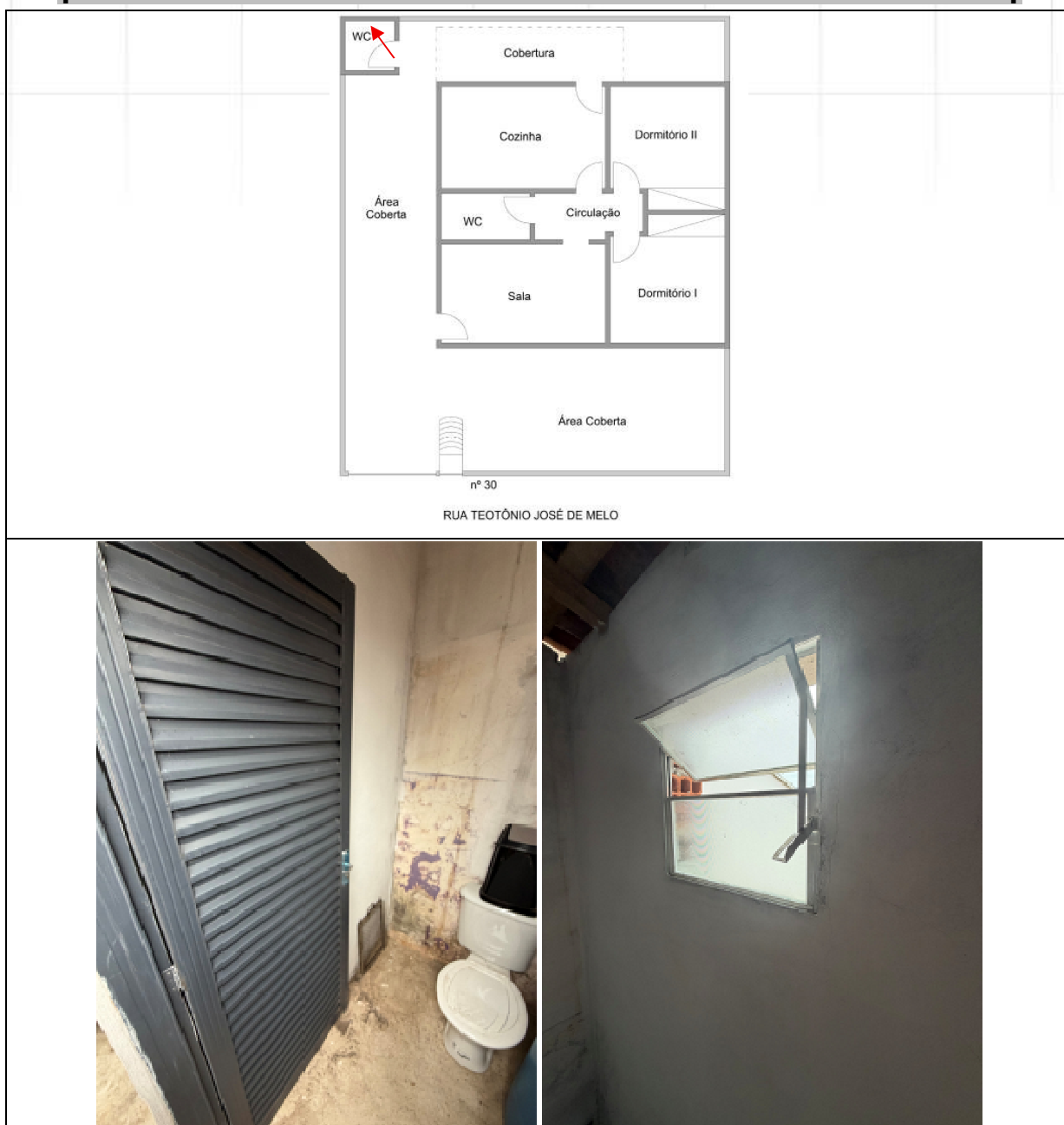
DETALHES DA PORTA E JANELA DO BANHEIRO EXTERNO.
